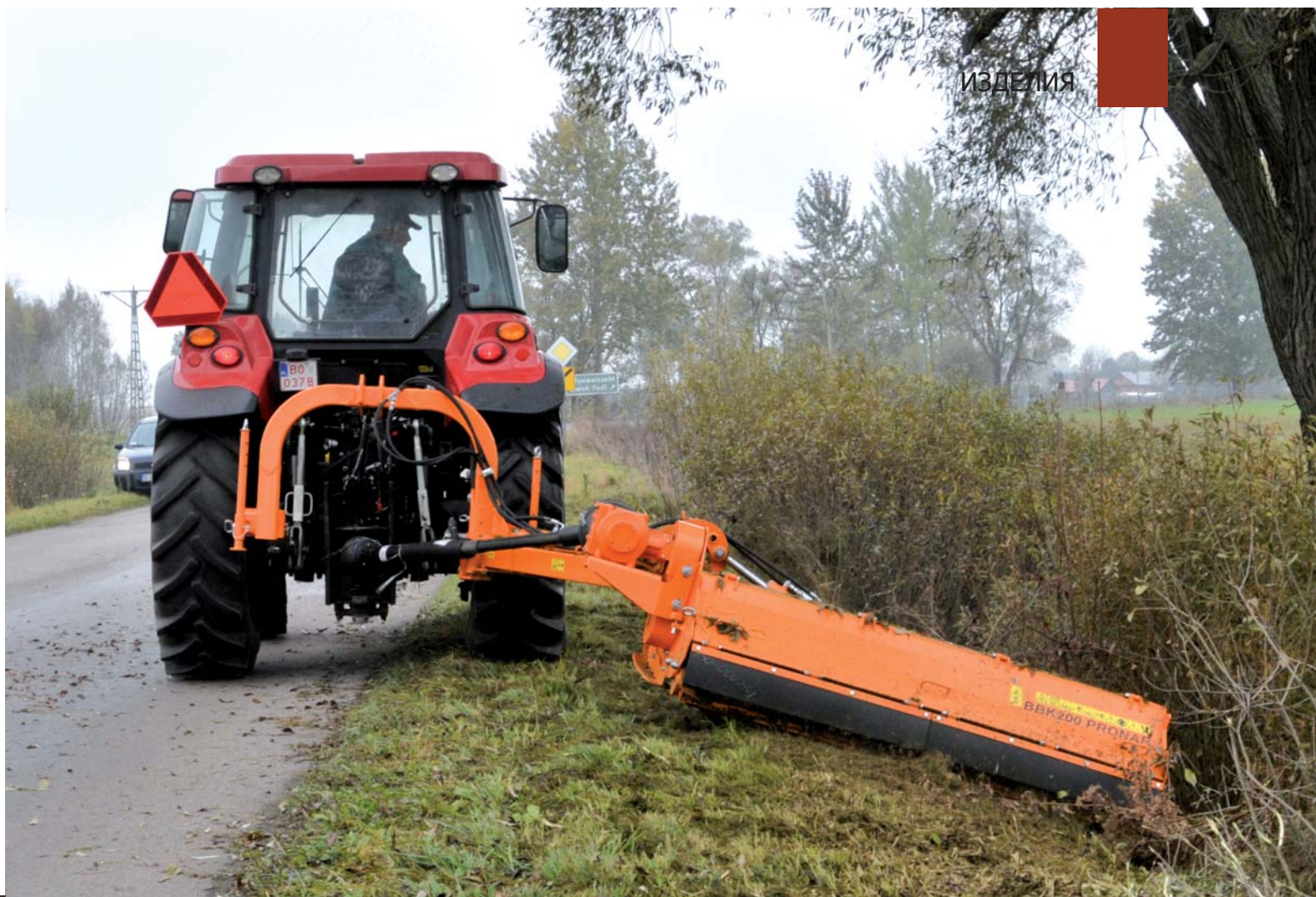
Фотография: Дисковая косилка с системой задней и боковой навески Pronar BBK200 во время кошения на обочинах
