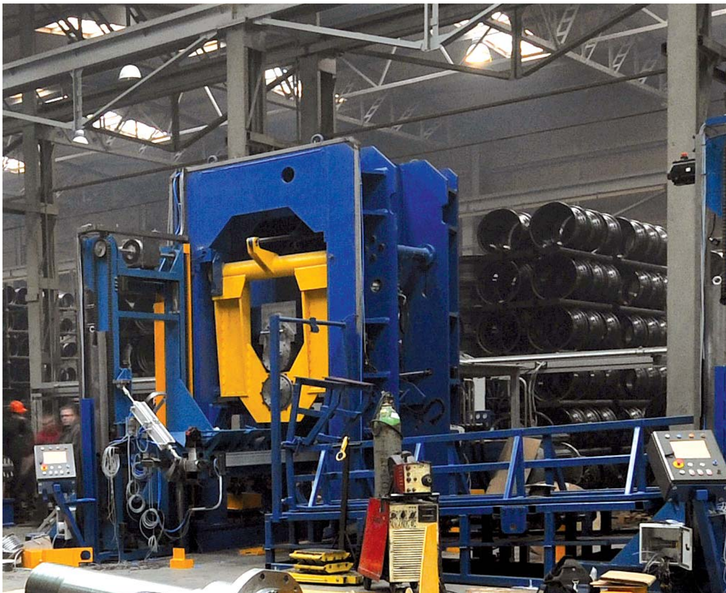
Фотография: Профилирующие станки линии МР7 во время запуска
