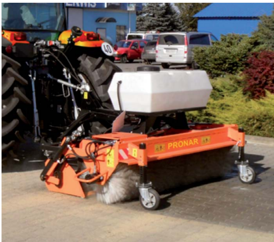
Фотография: Подметально-уборочная машина ZM-2000, установленная на задней СТН трактора
