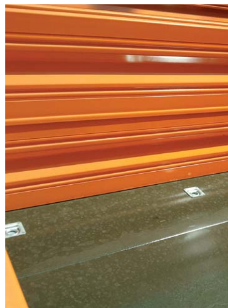
Фотография: Погрузочные захваты (8 шт.) прицепа PRONAR поддонов весом по 800 кг).
